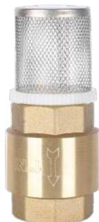
Válvula con cuerpo en bronce y rejilla de succión en acero inoxidable. Evita que el agua se desaloje completamente de la tubería y al encender a bomba, esta pueda succionar el agua sin riesgo de que esté llena de aire.
