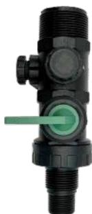
**Multiconector con llave de compuerta de 1 1/2 N.P.T. salida de 1 N.P.T reducción a 3/4 N.P.T. Tapón de descarga.**
