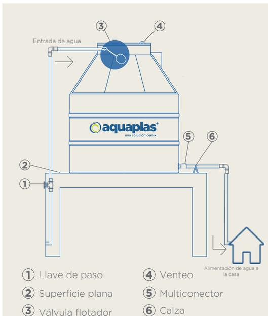
Para asegurar que el tinaco entregue suficiente presión, es necesario que el diferencial de alturas entre la salida del tinaco (multiconector) y la entrada del primer servicio sea de al menos 2 mts.
