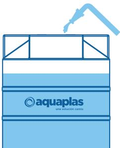
Antes de proceder al relleno de la fosa, se deberá de llenar la Cisterna con agua y colocar la tapa. Esto evitará que la cisterna colapse o tenga alguna deformación.
