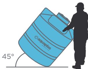
Para trasladar la cisterna, se debe girar sobre su borde para evitar fracturas o daños. (No se arrastra).
